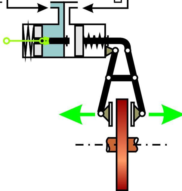
Federspeicherbremse pneumatisch gelöst
