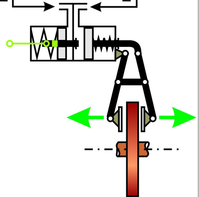
Federspeicherbremse mechanisch gelöst
